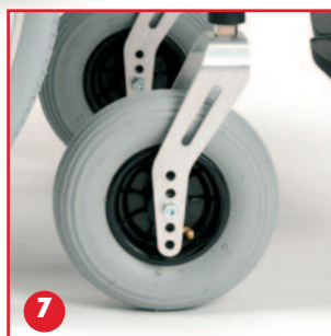
Regulación altura de asiento en múltiple posiciones
